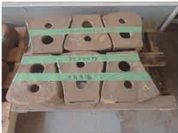
図7. ハンマーヘッド (6個、約300kg)
