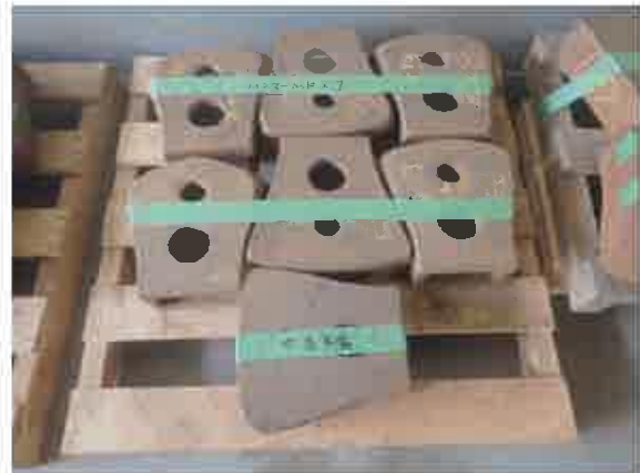
図8. ハンマーヘッド (7個、約350kg)
