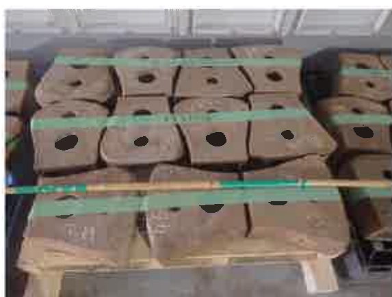
図5. ハンマーヘッド (11個、約550kg)
