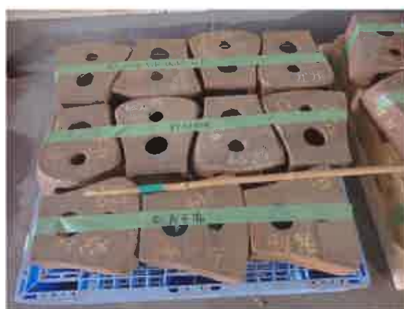
図6. ハンマーヘッド (11個、約550kg)
