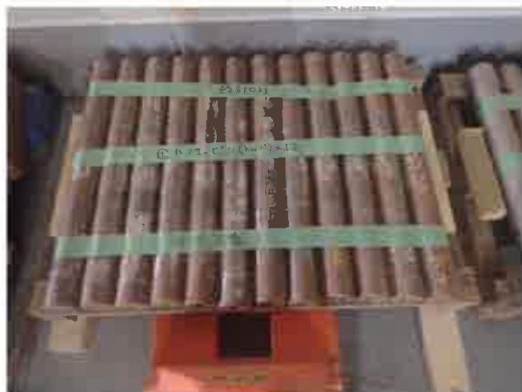
図1. ハンマーピン (12個、約310kg)
