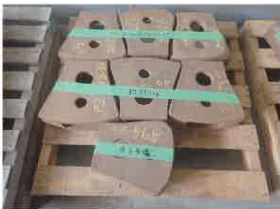
図9. ハンマーヘッド (7個、約350kg)
