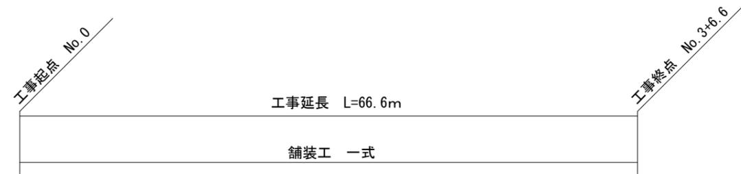
舗装打換え工：不陸整正(補足材)再生粒度調整碎石 RM-30(平均厚t=30)A=389.2m<sup>2</sup>、基層(再生粗粒度アスコン(20), t=50)A=389.2m<sup>2</sup>、表層(再生密粒度アスコン(13), t=40)A=389.2m<sup>2</sup>
