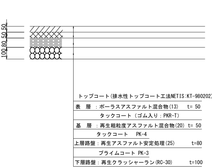
交差点部舗装 排水性舗装 (トップコート)
