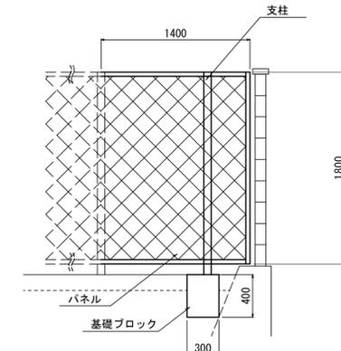
※復旧時、材料(支柱・パネル・基礎ブロック)は既設を再利用すること。
