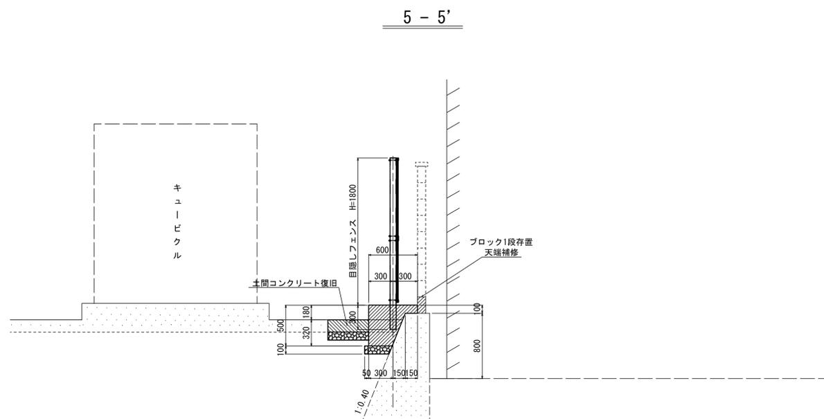
※キュービクル付近には高圧電線が埋設されているため、掘削時は十分注意すること。
