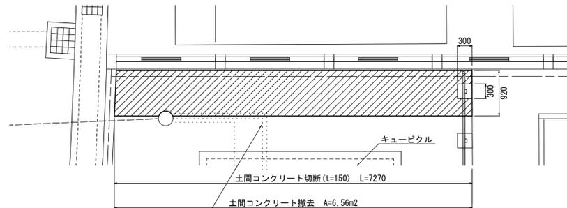
※キュービクル付近には高圧電線が埋設されており、設置位置は既存図面による想定位置であるため、施工時は十分注意すること。
