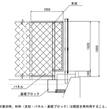
※復旧時、材料 (支柱・パネル・基礎ブロック) は既設を再利用すること。
