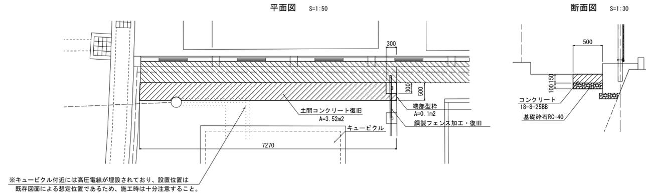
※キュービクル付近には高圧電線が埋設されており、設置位置は既存図面による想定位置であるため、施工時は十分注意すること。
