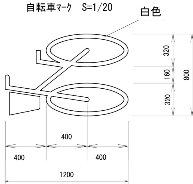
自転車マーク 断面構成図 (ノスケール)
