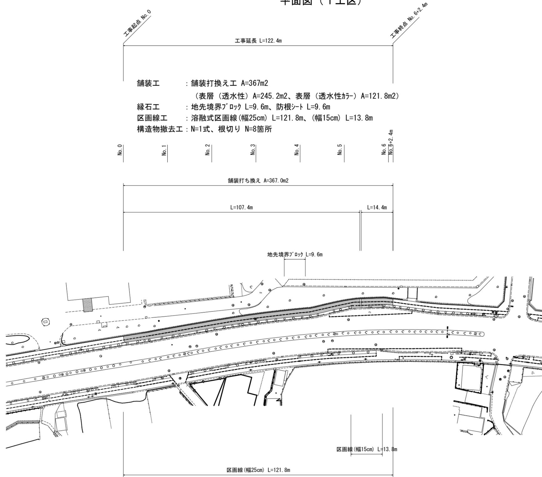
**舗装工** : 舗装打換え工 A=367m<sup>2</sup>
