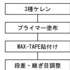
【支承防錆工フロー】
