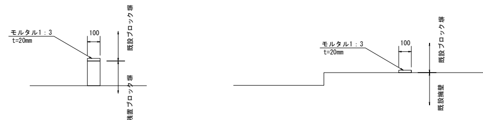
天端補修 (2) 控え壁部
