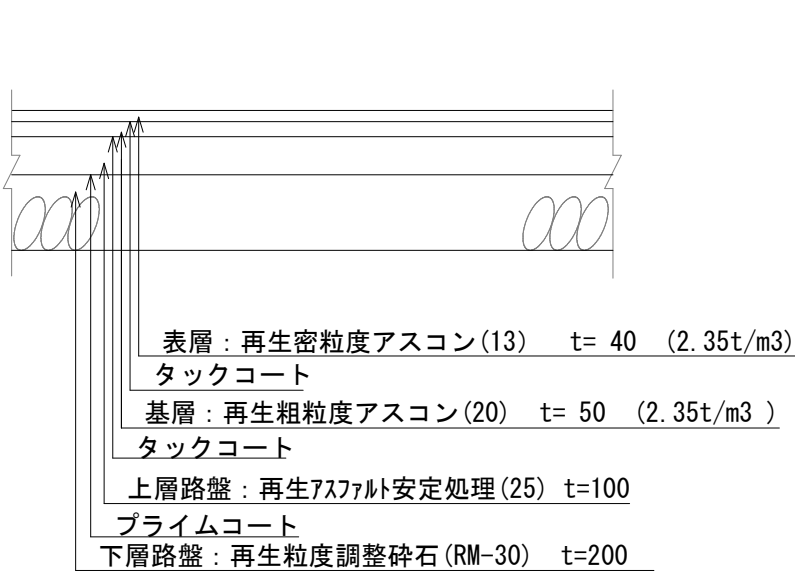
アスファルト舗装工（車道・路肩部）
