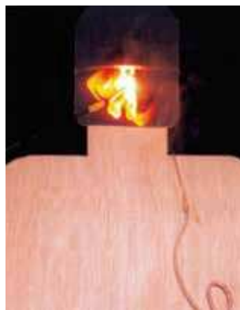
●たばこが有炎燃焼すると、容易にカニューラの吹き出し口に着火し、即燃的に燃焼する。
