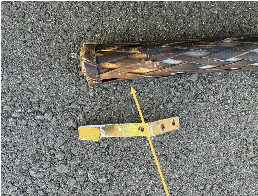
金具の外れた車除けバー（竹製）片方
