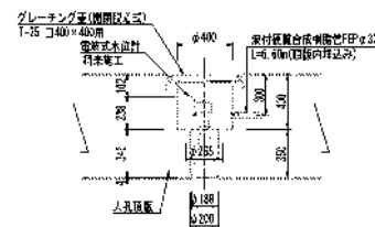
水位計設置用箱抜き部詳細図 S=1:20
